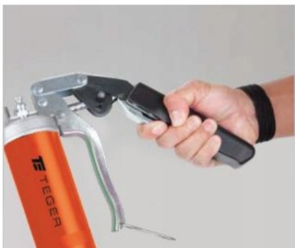
Naciśnij przycisk spustowy
