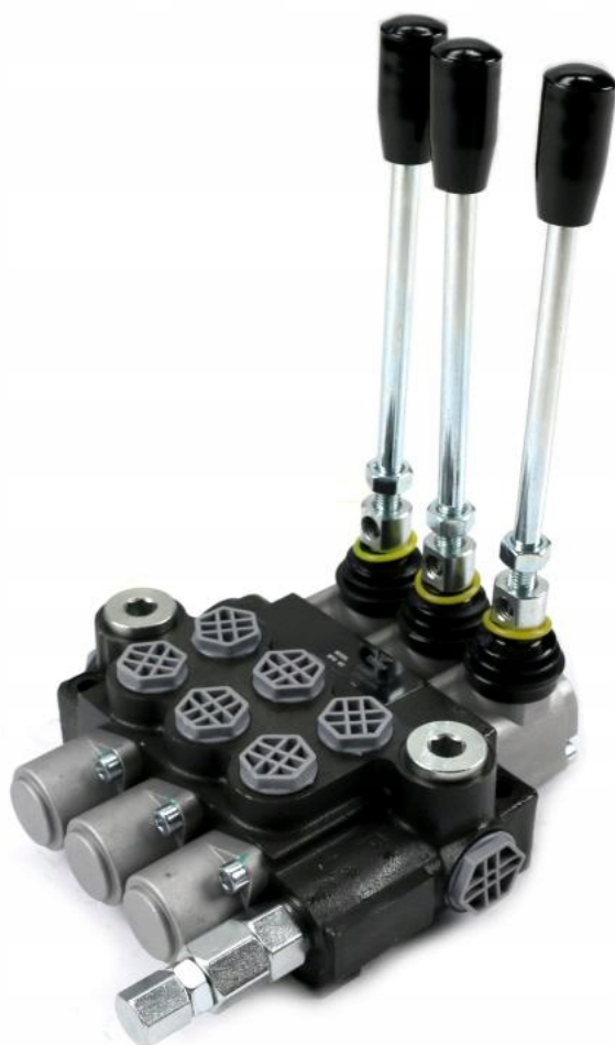
Rozdzielacz hydrauliczny 3-sekcyjny 40L z zatrząskami na 3 sekcjach VOIMA - monoblokowy z układem równoległym z neutralną pozycją środkową. Olej w pozycji neutralnej krąży między pompą hydrauliczną a zbiornikiem.
