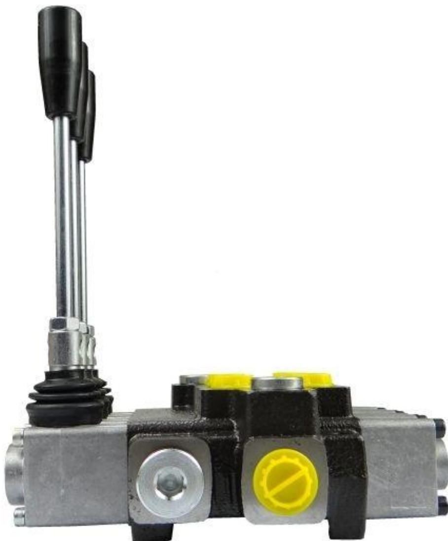
Rozdzielacz hydrauliczny 3-sekcyjny Waryński - monoblokowy z układem równoległym z neutralną pozycją środkową z zatrząskiem na 3 sekcjach.
