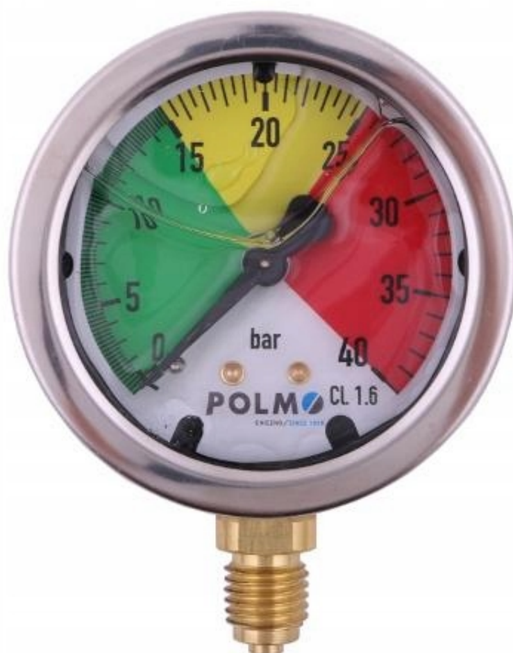
Manometr glicerynowy M63 0-40 bar gwint M12x1,5 dolne przyłącze, obudowa kwasoodporna, Opryskiwacz POLMO
