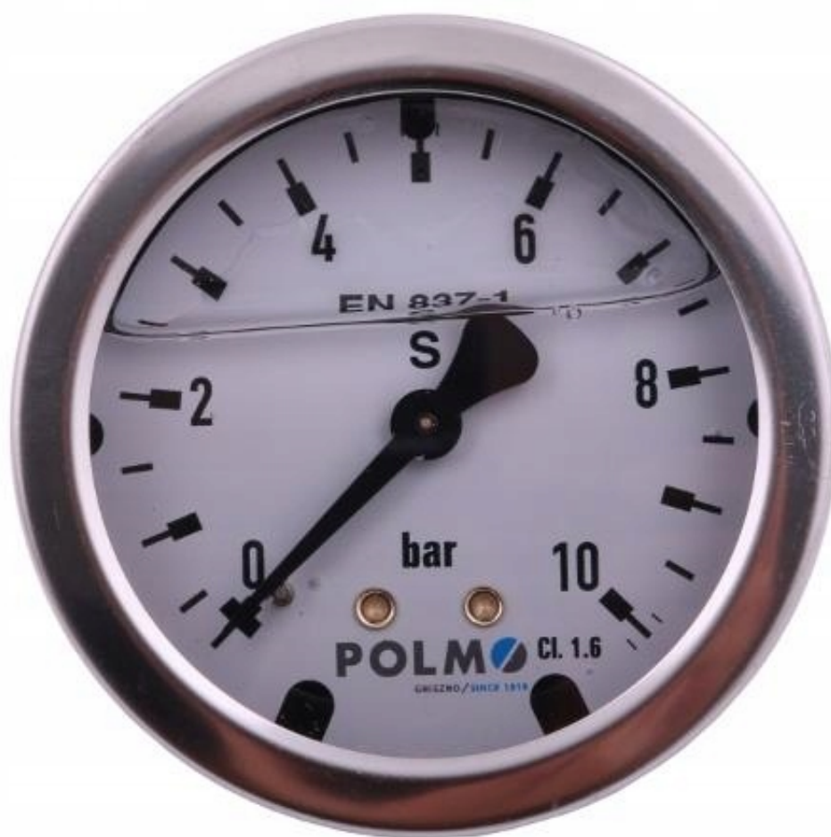
Manometr glicerynowy M63 0-10 bar tylne przyłącze G1/4" POLMO
