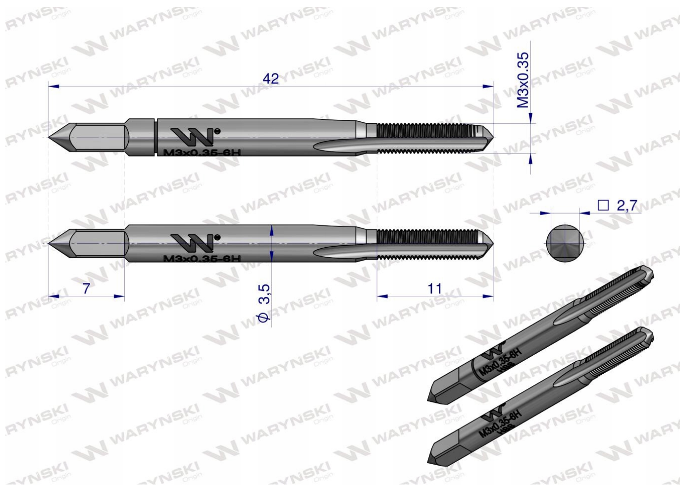
Gwintownki M3X0.35 ze stali szybko tnącej HSS komplet 2 szt (zgrubny, wykańczak) do gwintu metrycznego drobnozwojowego DIN2181 Waryński
